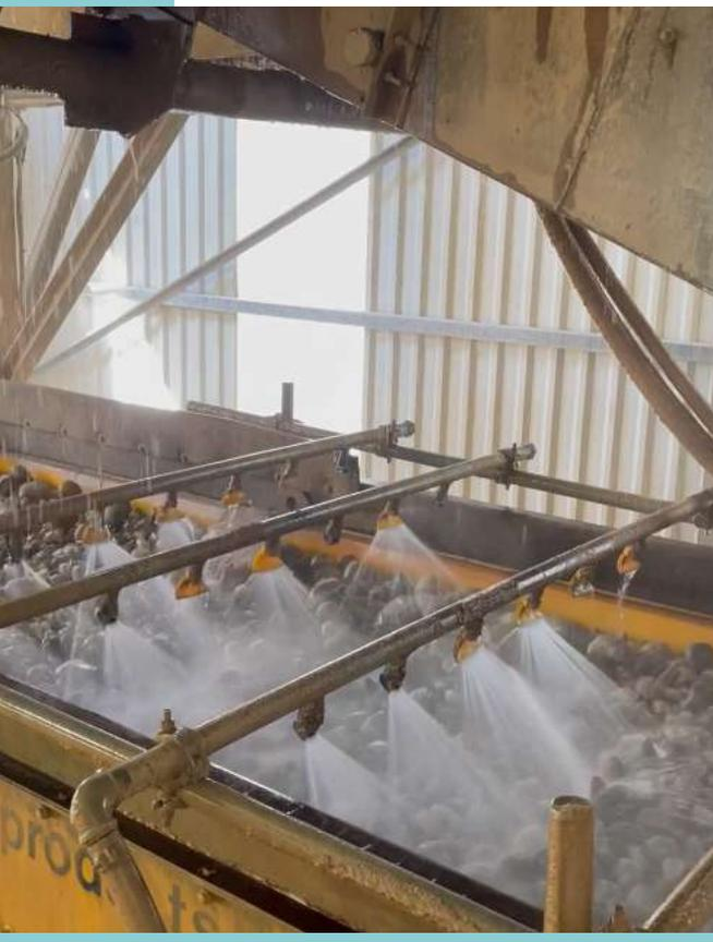
Dans les installations de concassage, les granulats sont lavés pour en extraire toutes traces d'argile ou de particules fines afin de pouvoir être stockés.
